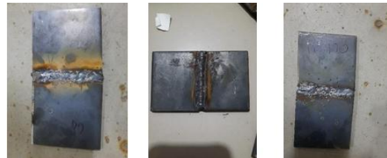
(a) (b) (c) Gambar 3. Hasil pengelasan 80A (a), 100A (b), 120A (c) Sumber: Pribadi
