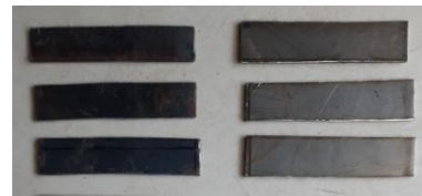
Gambar 2. Material stainless steel dan baja karbon rendah
