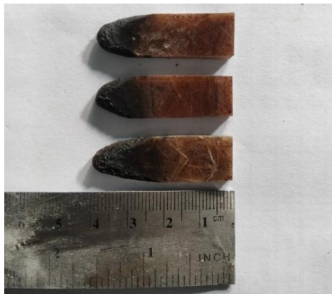
Gambar 14. Hasil Pengujian Bakar Sumber : Pribadi
