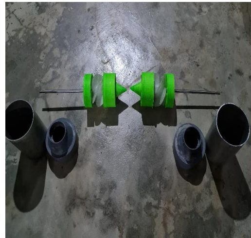
Gambar 4. Komponen utama waterjet thruster Hasil 3D Printing
