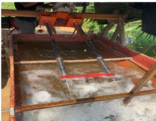
Gambar 4. Pengujian Daya Dorong Type Twin
