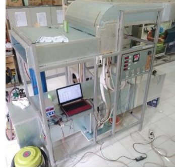
Gambar 1. Setup eksperimen sistem pengujian AC split
