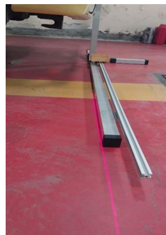
Gambar 13. Laser yang memandu kelurusan batang pemancar
