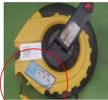
Gambar 8. Pita ukur terkalibrasi
