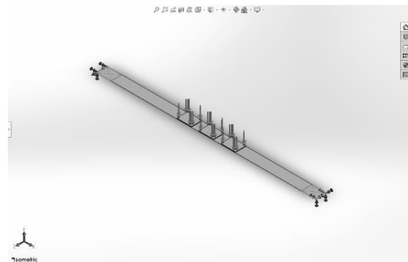
Gambar 3. Letak pembebanan dan fixed support
