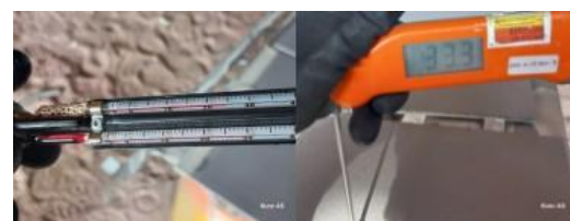
Gambar 8. Pemeriksaan Kondisi Temperature dengan sling psychrometer
