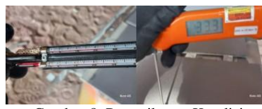
Gambar 8. Pemeriksaan Kondisi Temperature dengan sling psychrometer
