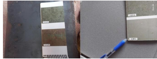
Gambar 3. Kondisi Material Sebelum dan Sesudah Proses Sandblasting sesuai SSPC-SP5
