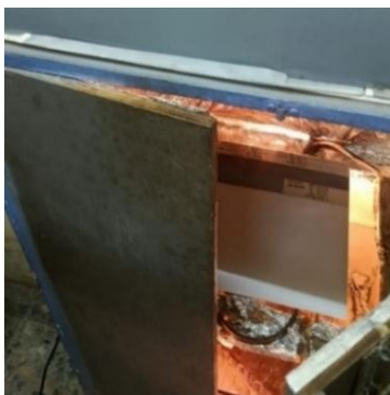
Gambar 11. Tahapan pengeringan coating pada specimen uji .
