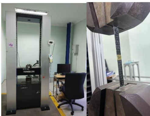
Gambar 2. Pengujian tarik spesimen komposit menggunakan UTM.
