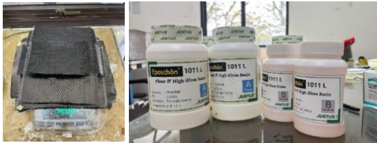
Gambar 1. Serat karbon yang sedang ditimbang dan resin 1011 L serta hardener
