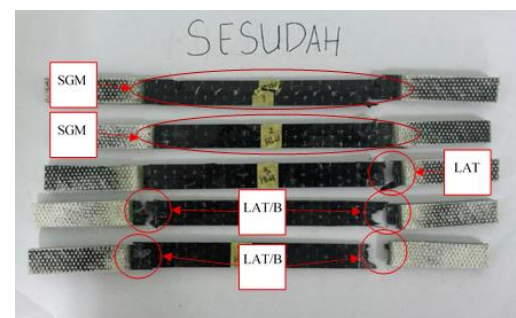
Gambar 3. Kondisi spesimen metode HLU yang telah diuji tarik
