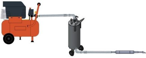
Gambar 4. Sistem kerja mesin pembusa
