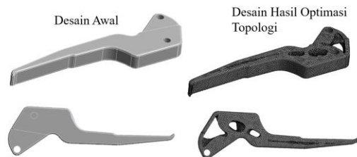
Gambar 12. Perbandingan Desain Handle rem sebelum dan sesudah optimasi topologi
