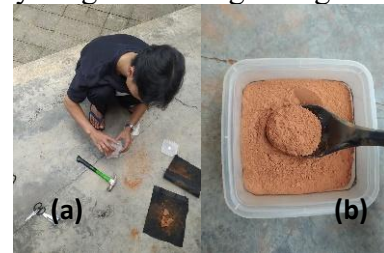
Gambar 6. Proses penyaringan serbuk (keterangan gambar : (a) penumbukan dan penyaringan, (b) serbuk genteng berukuran 75 \mu m)
