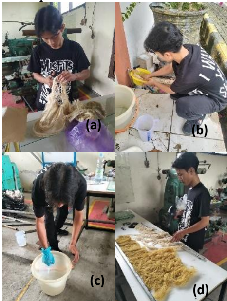
Gambar 3. Persiapan Serat (keterangan gambar : (a) pemilihan serat, (b) pencucian serat, (c) perendaman serat dengan NaOH, (d) pengeringan serat)
