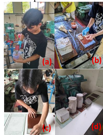
Gambar 8. Proses pembuatan spesimen (keterangan gambar : (a) pengadukan matriks dan serbuk, (b) pendistribusian serat, (c) finishing, (d) proses curing)
