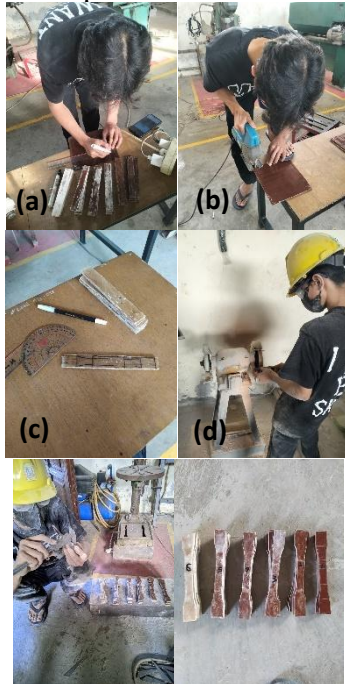
Gambar 9. Proses preparasi spesimen (keterangan gambar : (a) pengukuran spesimen, (b) pemotongan spesimen, (c) Standar spesimen ASTM D638-1, (d) Pembentukan spesimen, (e) QC spesimen, (f) spesimen siap uji
