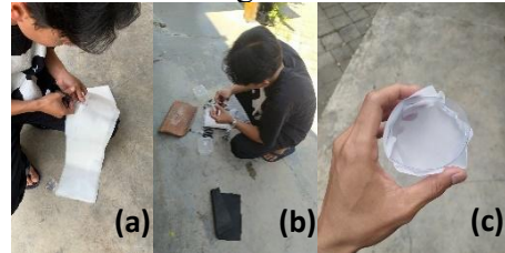
Gambar 5. Pembuatan saringan (keterangan gambar : (a) pemotongan kain nilon, (b) pembentukan cetakan saringan, (c) saringan serbuk siap pakai)
