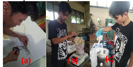
Gambar 7. Tahap penimbangan bahan (keterangan gambar : (a) pemotongan serat, (b) penimbangan serat, (c) penimbangan matriks dan serbuk)
