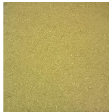
Gambar 1. Papan partikel satu lapis berbahan limbah batang jagung
