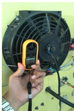
Gambar 1. Pengambilan data kecepatan udara
