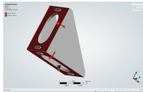
Gambar 7. Titik Force Sambungan Angel Corner
