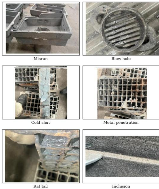
Gambar 1. Dokumentasi visual cacat dominan pada deckdrain
