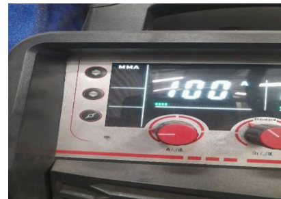
Gambar 4. Mesin Las SMAW Arus Konstan 100 A
