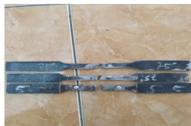
Gambar 15. Hasil Uji Tarik Sudut Elektroda 75^\circ
