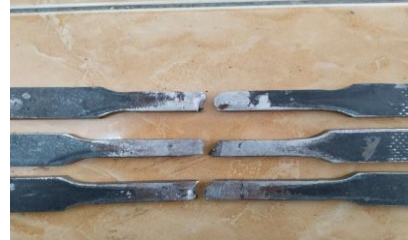
Gambar 14. Hasil Uji Tarik Sudut Elektroda 60^\circ
