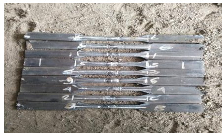
Gambar 10. Spesimen Uji Tarik Sebelum Finishing
