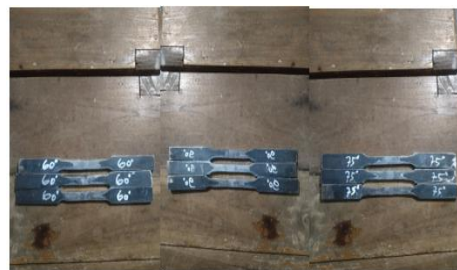
Gambar 11. Spesimen Uji Tarik Setelah Finishing
