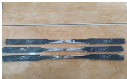
Gambar 16. Hasil Uji Tarik Sudut Elektroda 90°
