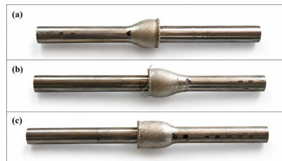
Gambar 2. Spesimen hasil pengelasan gesek putar (Rotary Friction Welding). (a) Spesimen 1, (b) Spesimen 2, (c) Spesimen 3.
