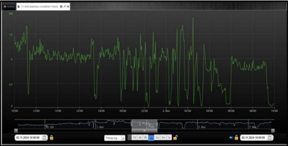
Gambar 3. Tren Vibrasi Cement Mill pada Kondisi Kebocoran Strength Enhancer
