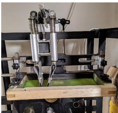
Gambar 5. Posisi screen yang tepat
