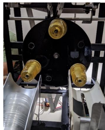
Gambar 7. Posisi molding sejajar dengan wadah penampung
