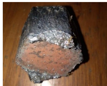
Gambar 5 Defect Hasil Pemotongan
