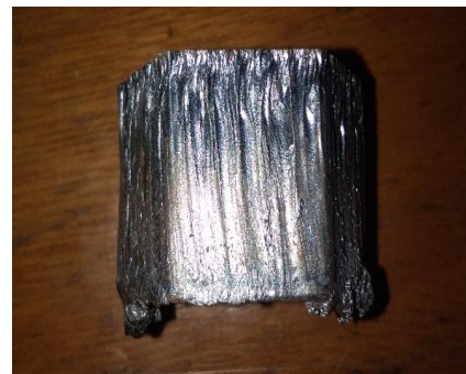
Gambar 4 Dross Hasil Pemotongan
