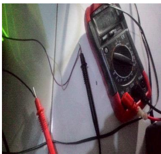
Gambar 6. Pengukuran arus pada motor
