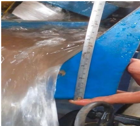
Gambar 11. Pengukuran tinggi debit air pada Weir.
