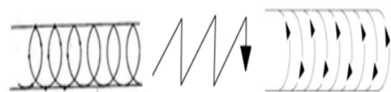
Gambar 3. Gerakan elektroda spiral, zig-zag dan gerakan elektroda U
