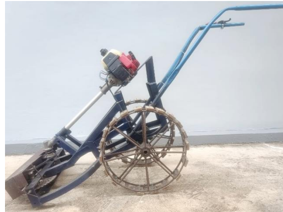
Gambar 4. Hasil rekayasa mesin pemotong batang padi
