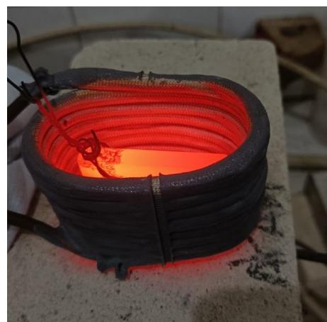
Gambar 3. Proses Pemanasan Spesimen sebelum dilakukan Austempering Larutan Garam
