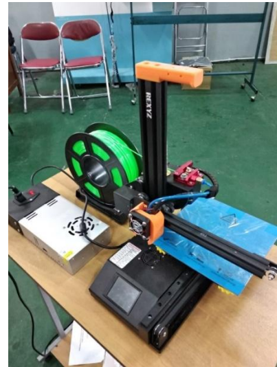
Gambar 2. Proses pembuatan spesimen pengujian dari filamen sampah plastik di mesin 3D printer
