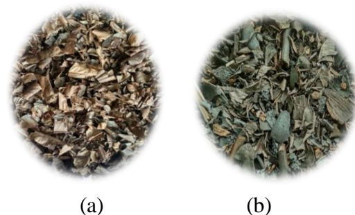
Gambar 4. Sampah Torefaksi Temperatur 275°C (a) dan 300°C (b)
