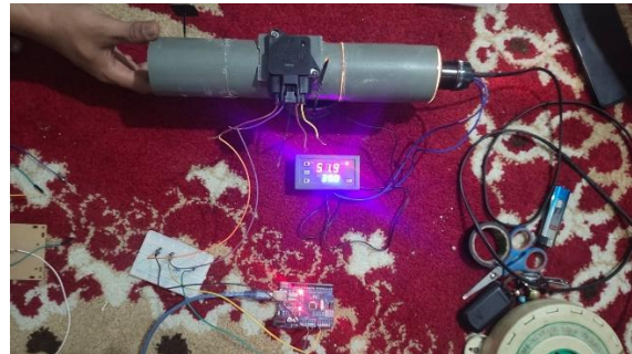
Gambar 2 Pengujian tegangan output sensor IAT
