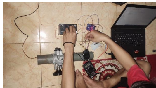
Gambar 4 Pengujian tegangan output sensor MAF
