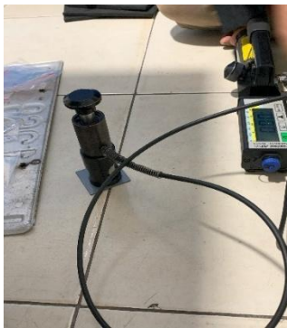
Gambar 3. Proses pengujian pull-off test Sumber : Pribadi
