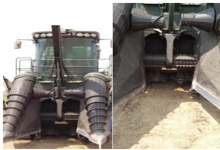
Gambar 4. Dua feeder coloum Sugarcane Harvester (kiri) yang mengarahkan batang tebu masuk ke slicer (kanan)
