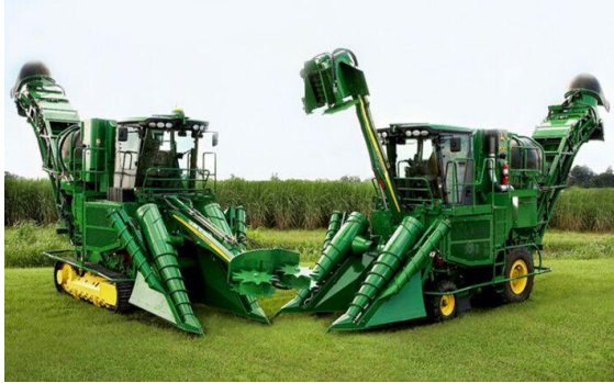
Gambar 3. John Deere Sugarcane Harvester berpengerak rantai (kiri) dan berpengerak roda (kanan)
