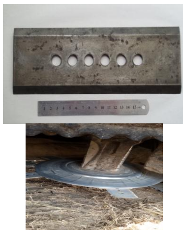
Gambar 1. Slicer Sugarcane Harvester (atas), Slicer yang terpasang pada disc holder mesin (bawah)
