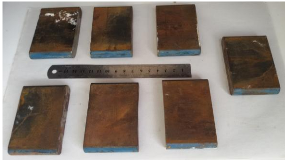
Gambar 6. Potongan pegas daun truk bekas tebal 14 mm.
