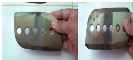
Gambar 5. Slicer Sugarcane Harvester mengalami aus (kiri) dan mengalami aus dan pecah (kanan)
